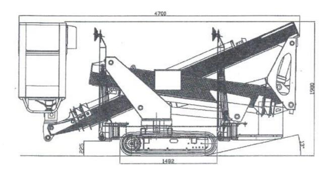
Fig. 1.1  $Pressione \ specifica \ al \ suolo \ in \ traslazione \ 0.45 \ kg/cm^2$
